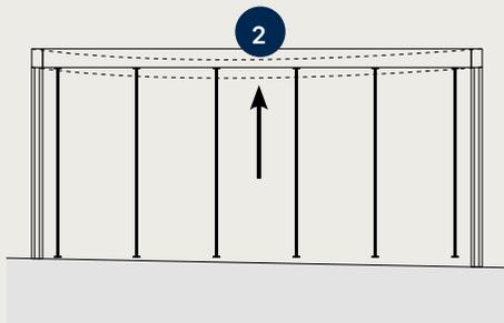
2 VERSTELLBARE TRÄGERPRO-FILE FÜR HORIZONTALER UNTERSTÜTZUNG DES OBEREN RAHMENS
