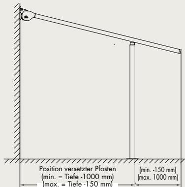
Ein versetzter Pfosten bei Lapure wird durch Eingabe des gewünschten Abstands vom Wandanschluss eingegeben.
