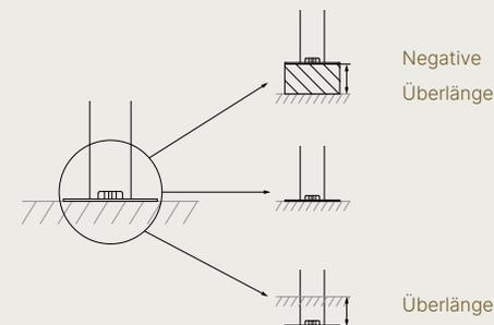
Oder wenn z. B. einer der Pfosten auf einer kleinen Mauer stehen soll, kann dieser „verkürzt“ werden (= negative Überlänge).
