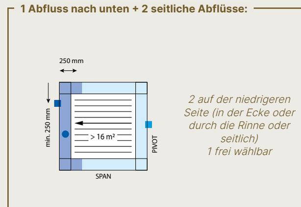
**Hinweis:** Bei Aero infinity wird die Dachfläche pro Dachteil betrachtet (Fläche von 1 Dachteil = Spann x Pivot / 2)
