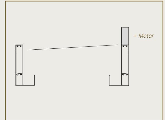
Die Wasserabflussrichtung der Lamellen führt von der Motorseite weg. Auf Wunsch kann diese Richtung aber auch zur Motorseite hin erfolgen. Dadurch ergibt sich eine andere Antriebsleiste.
