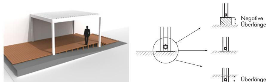
Positive Überlänge ist möglich bis zur maximalen Durchgangshöhe [2800 mm] + 500 mm [= 3300 mm].
