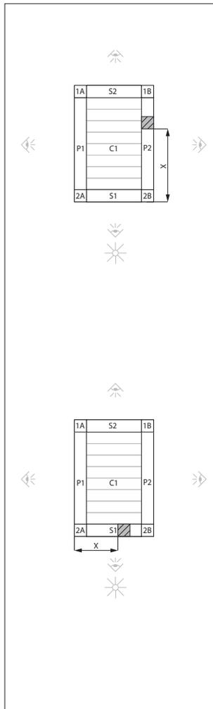
X = Position der Zwischenpfostens [mm]
